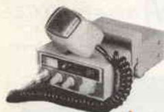
LAFAYETTE 2400 240 canali AM-FM-SSB-CW; frequenza 26.515-27.855 MHz; potenza 4,5 W regolabili (12 W in SSB).
